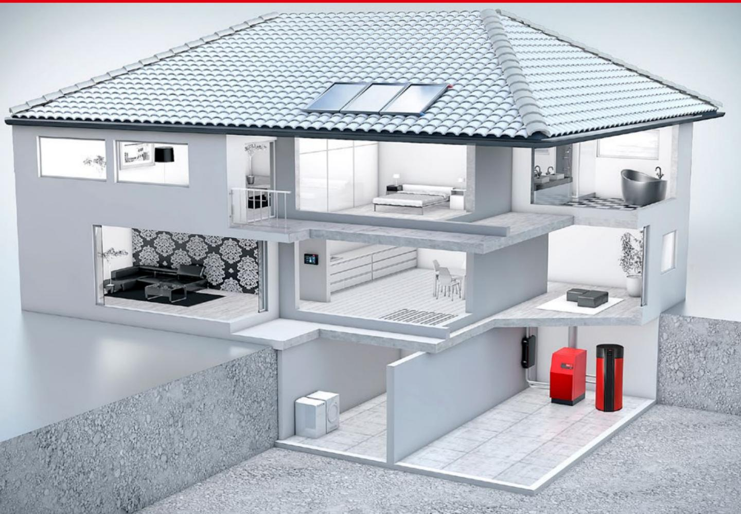
Solution standard 7: chauffe-eau pompe à chaleur combiné à une chaudière à mazout ou à gaz et une installation photovoltaïque
