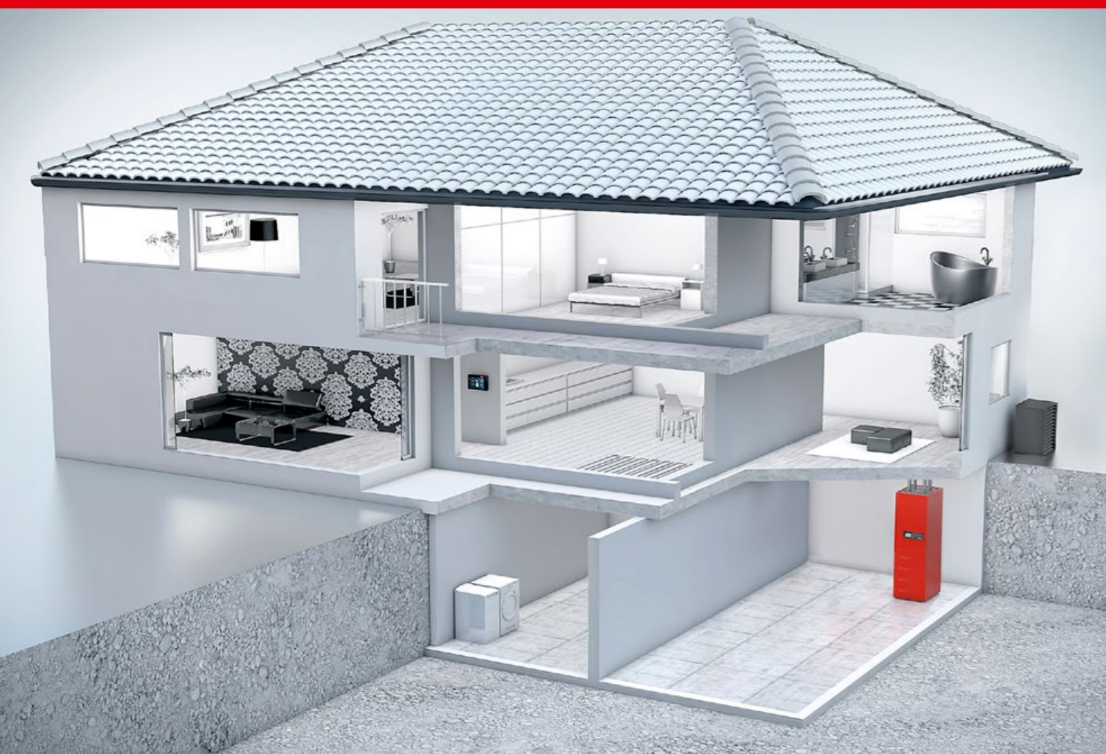
Soluzione standard 3: pompa di calore aria/acqua
