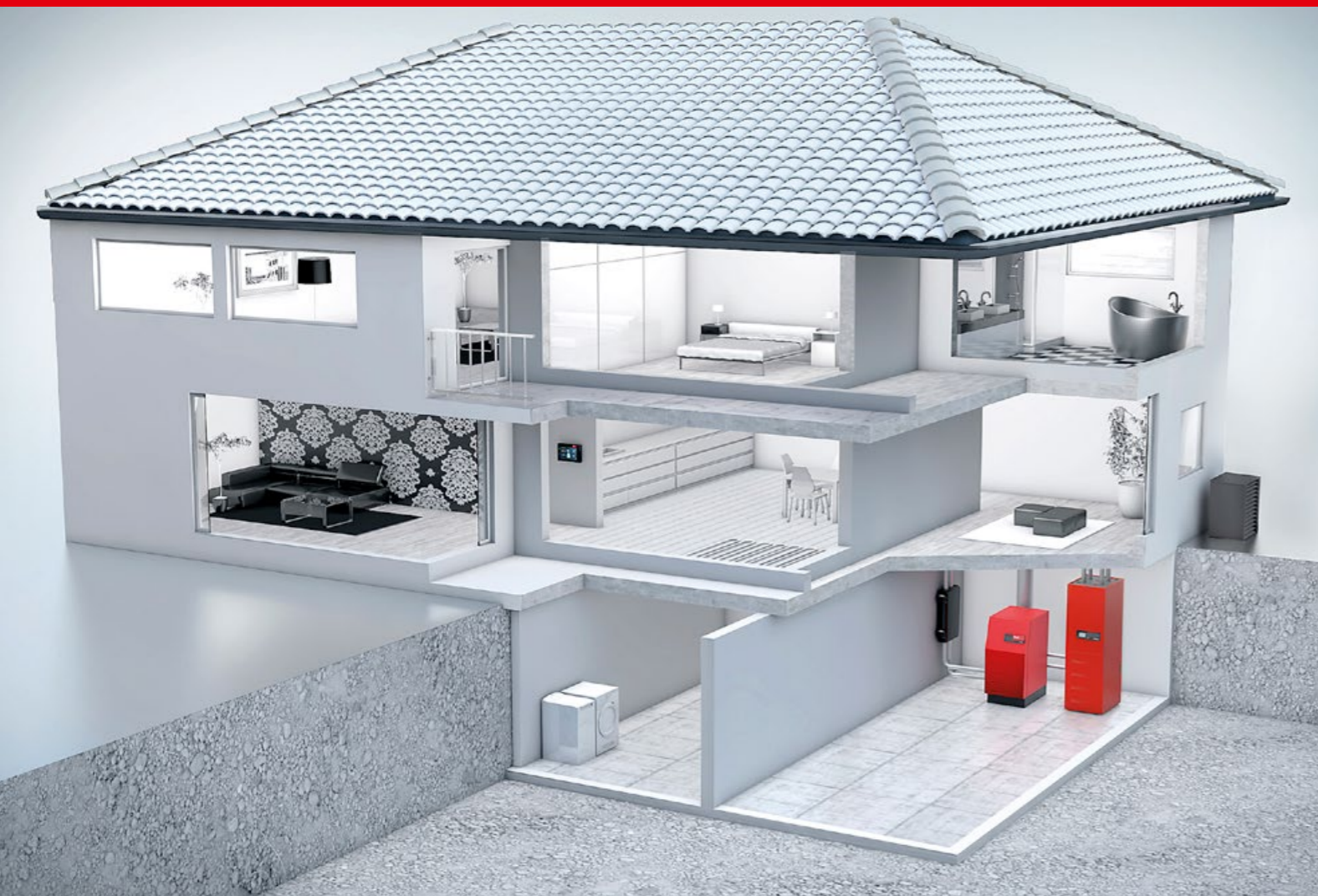
Soluzione standard 10: sistema ibrido olio combustibile con pompa di calore aria/acqua
