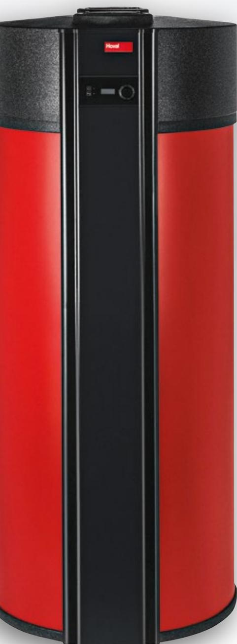
Accumulateur d'eau sanitaire préaccordé avec pompe à chaleur air/eau intégrée pour le chauffage de l'eau sanitaire. Accumulateur en acier, émaillé à l'intérieur, avec protection anticorrosion et isolation thermique. Exécution disponible avec échangeur de chaleur standard supplémentaire intégré.
