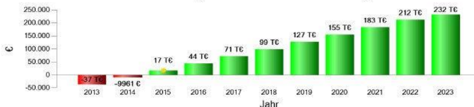
Amortisation (mit BHKW / ohne neuen Kessel)
