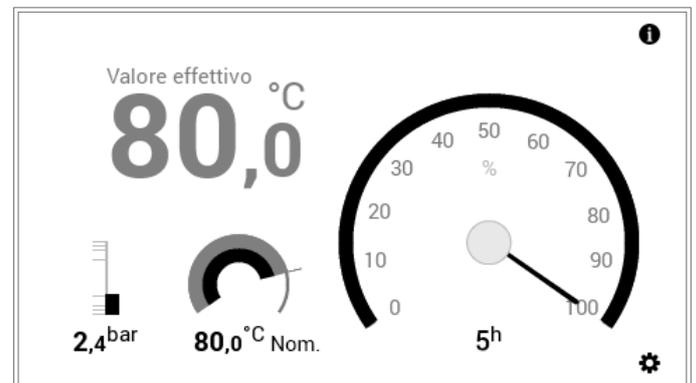
La schermata di avvio «Industrial» viene utilizzata per lo più per impianti di grandi dimensioni. In tale caso vengono visualizzate solo la temperatura del generatore di calore attuale, la pressione dell'acqua (opzionale), la temperatura del generatore di calore desiderata, nonché le ore di funzionamento e la potenza.
