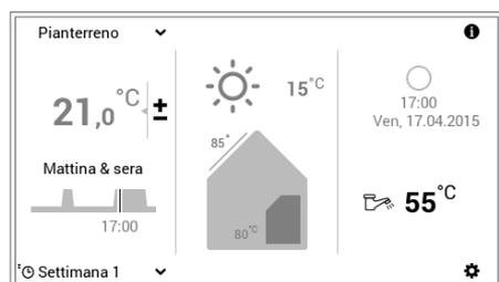
5 L'attuale temperatura dell'acqua calda viene visualizzata nella schermata di avvio e aumenta ovvero diminuisce fino al raggiungimento della temperatura dell'acqua desiderata.
