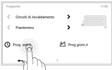
3 Compilare la panoramica per la selezione del circuito di riscaldamento e del programma. Selezionare il circuito di riscaldamento desiderato e successivamente **Programmi settimanali**.
