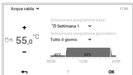
2 Selezionare mediante tocco il **programma base acqua calda** oppure il **programma giornaliero acqua calda**.
