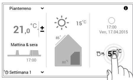
1 Selezionare mediante tocco la **temperatura dell'acqua calda** visualizzata.
