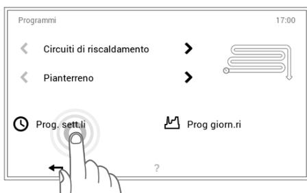
3 Comparare la panoramica per la selezione del circuito di riscaldamento e del programma. Selezionare il circuito di riscaldamento desiderato e successivamente **Programmi settimanali**.
