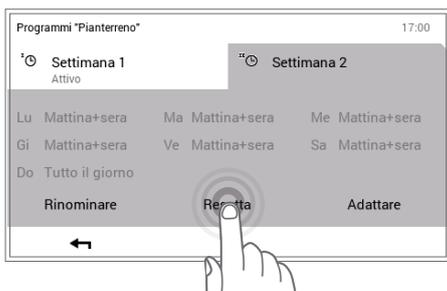
4 Selezionare il programma settimanale desiderato (esempio: Settimana 2). Mediante tocco del pulsante **Resettare** vengono ripristinati i valori standard delle impostazioni nel programma settimanale selezionato.
