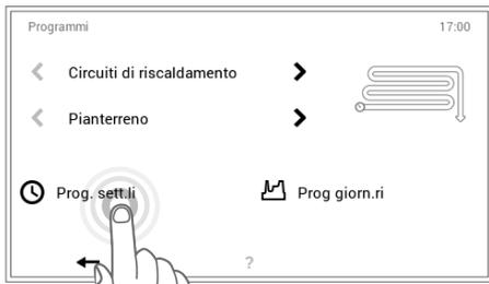
3 Comparare la panoramica per la selezione del circuito di riscaldamento e del programma. Selezionare il circuito di riscaldamento desiderato e successivamente **Programmi settimanali**.
