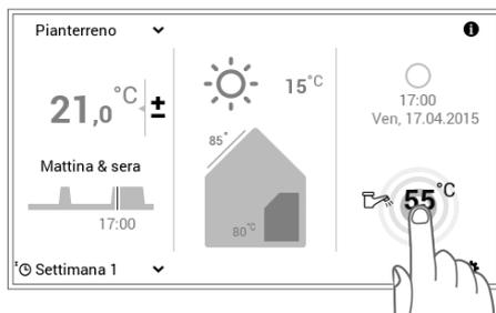
1 Selezionare mediante tocco la **temperatura dell'acqua calda** visualizzata.
