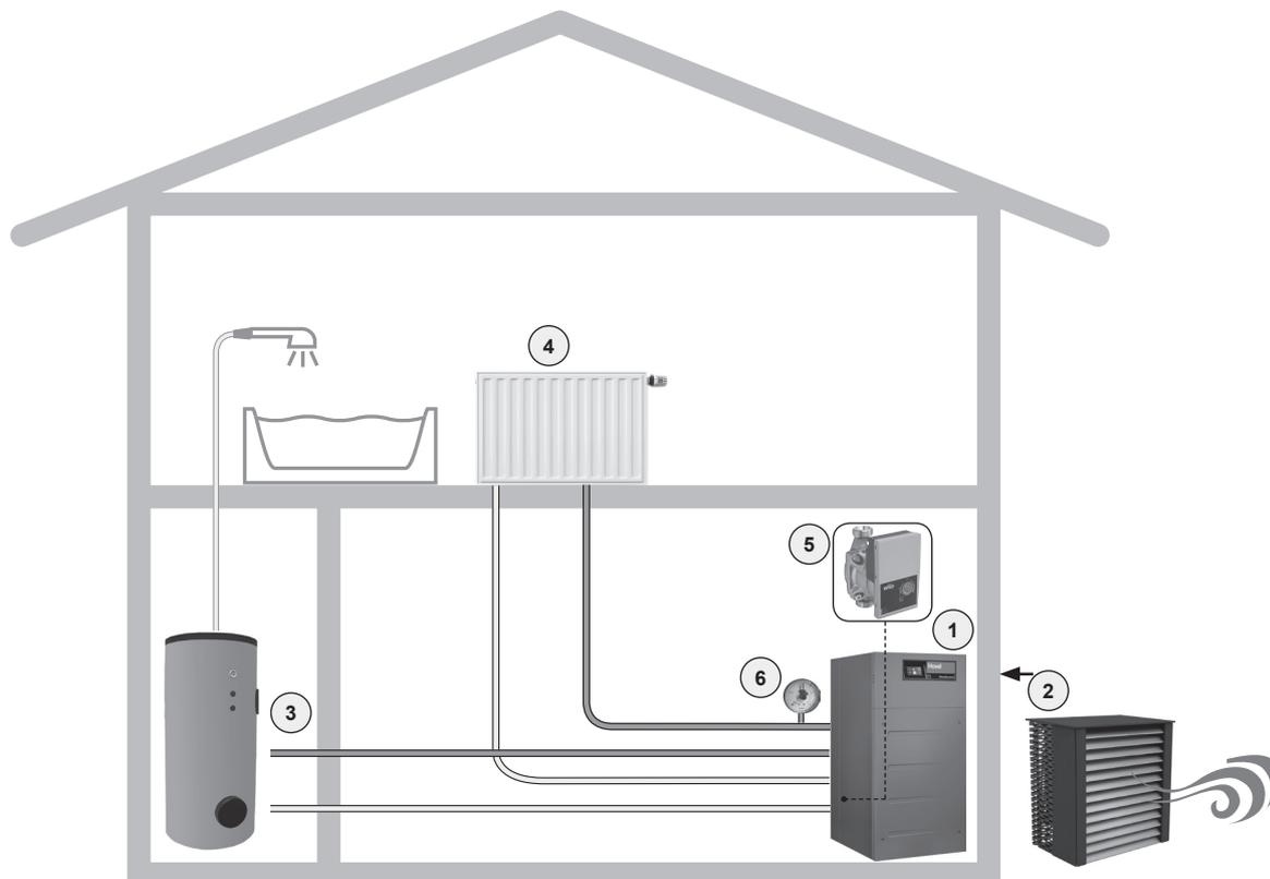
L'acqua di riscaldamento riscaldata dalla caldaia viene convogliata ai radiatori oppure viene utilizzata per il riscaldamento dell'acqua calda (bollitore).
