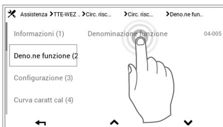
La denominazione del vostro circuito di riscaldamento può essere effettuata attraverso **Schermata di avvio > Menù principale > Assistenza > TTE-WEZ > Circuito riscaldamento > Selezionare circuito riscaldamento > Deno.ne funzione (^v) > Selezionare denominazione funzione > Selezionare circuito riscaldamento > Immissioni tastiera**. Tenere conto del fatto che il vostro impianto può comprendere uno o parecchi circuiti di riscaldamento.
