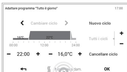
**2** Per poter impostare le temperature ambiente desiderate per il modo di raffrescamento, deve essere visualizzato **Modo raffresc.** - altrimenti modificare mediante tocco.
