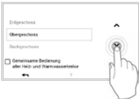
2 Mit den **vertikalen Pfeilen** (↕) den gewünschten Heizkreis auswählen und mit **OK** bestätigen.
