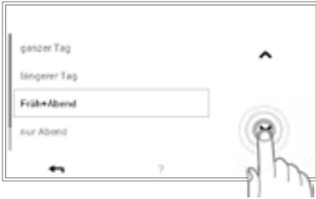
6 Mit den **vertikalen Pfeilen** (↕) das neue Tagesprogramm auswählen und mit **OK** bestätigen.
