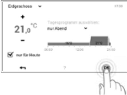
**4** Das ausgewählte Tagesprogramm wird nun mit den dazugehörigen Schaltzyklen sowie der Raumtemperatur angezeigt.
