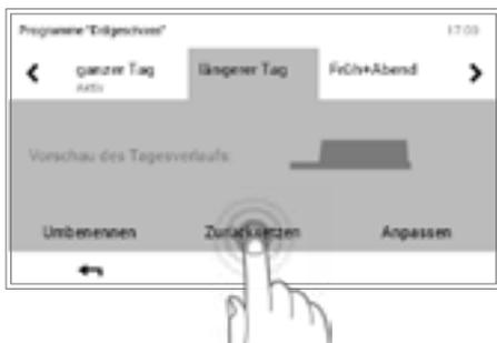
4 Gewünschtes Tagesprogramm (Beispiel: längerer Tag) mit den **horizontalen Pfeilen** (↔) anwählen. Durch Berühren der Schaltfläche **Zurücksetzen** werden die Einstellungen im angewählten Tagesprogramm auf die Standardwerte zurückgesetzt.
