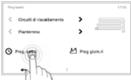
3 Comparare la panoramica per la selezione del circuito di riscaldamento e del programma. Selezionare il circuito di riscaldamento desiderato e successivamente **Programmi settimanali**.
