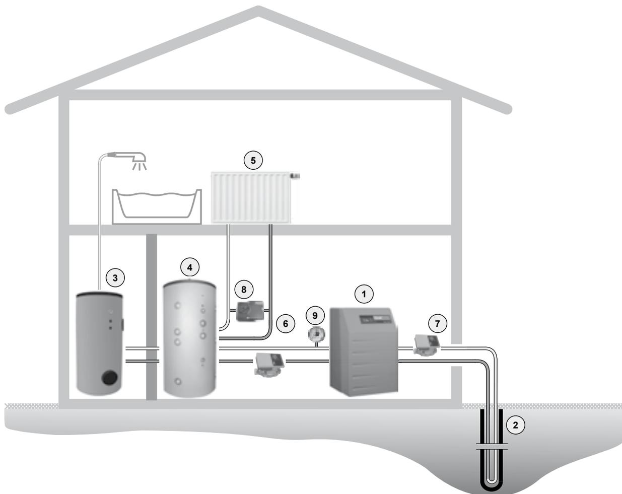
L'acqua di riscaldamento riscaldata dalla Thermalia® dual viene convogliata ai radiatori, oppure viene utilizzata per il riscaldamento dell'acqua calda (bollitore).
