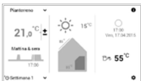
7 L'attuale temperatura dell'acqua calda viene visualizzata nella schermata di avvio e aumenta o diminuisce fino al raggiungimento della temperatura dell'acqua desiderata per l'assenza.
