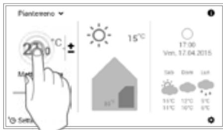
1 Selezionare mediante tocco la **temperatura ambiente** visualizzata.
