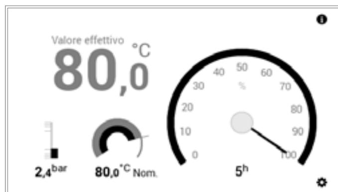
La schermata di avvio «Industrial» viene utilizzata per lo più per impianti di grandi dimensioni. In tale caso vengono visualizzate solo la temperatura del generatore di calore attuale, la pressione dell'acqua (opzionale), la temperatura del generatore di calore desiderata, nonché le ore di funzionamento e la potenza.
