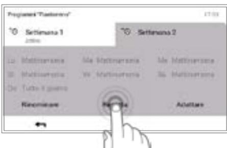
4 Selezionare il programma settimanale desiderato (esempio: Settimana 2). Mediante tocco del pulsante **Resettare** vengono ripristinati i valori standard delle impostazioni nel programma settimanale selezionato.
