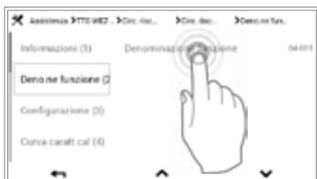
La denominazione del vostro circuito di riscaldamento può essere effettuata attraverso **Schermata di avvio > Menù principale > Assistenza > TTE-WEZ > Circuito riscaldamento > Selezionare circuito riscaldamento > Deno.ne funzione (⚙) > Selezionare denominazione funzione > Selezionare circuito riscaldamento > Immissioni tastiera**. Tenere conto del fatto che il vostro impianto può comprendere uno o parecchi circuiti di riscaldamento.
