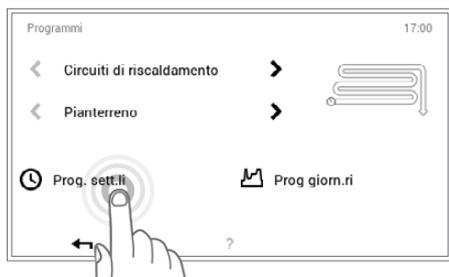
3 Comprire la panoramica per la selezione del circuito di riscaldamento e del programma. Selezionare il circuito di riscaldamento desiderato e successivamente **Programmi settimanali**.
