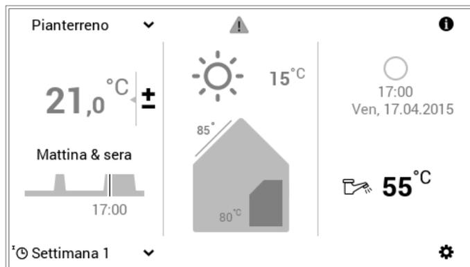
La schermata di avvio del generatore di calore visualizza informazioni dettagliate relative al generatore di calore. In combinazione con il TopTronic® E online possono essere visualizzate sia le previsioni meteo come pure l'attuale fase lunare.
