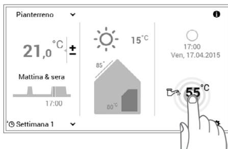
1 Selezionare mediante tocco la **temperatura dell'acqua calda** visualizzata.
