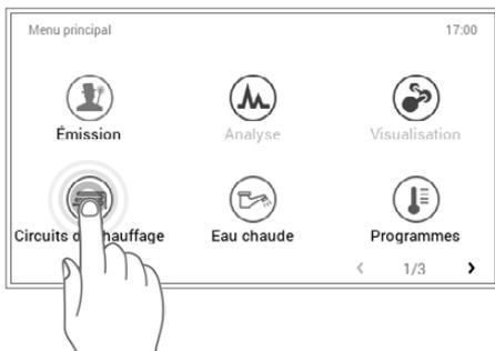
2 Sélectionner le menu **Circuits de chauffage** en l'effleurant.
