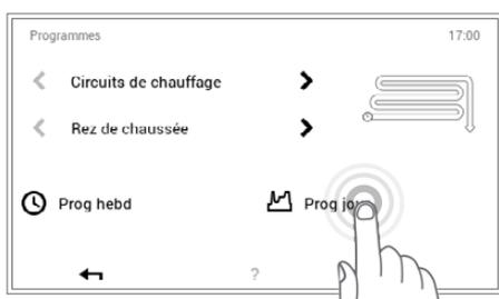
3 L'aperçu pour la sélection du circuit de chauffage et du programme s'affiche. Sélectionner d'abord le circuit de chauffage puis les **programmes journaliers**.
