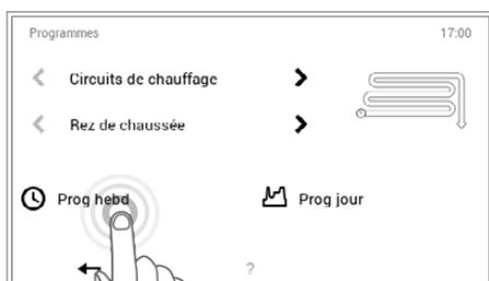
3 L'aperçu pour la sélection du circuit de chauffage et du programme s'affiche. Sélectionner d'abord le circuit de chauffage puis les **programmes hebdomadaires**.
