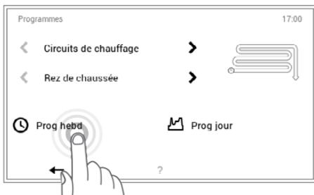
3 L'aperçu pour la sélection du circuit de chauffage et du programme s'affiche. Sélectionner d'abord le circuit de chauffage puis les **programmes hebdomadaires**.
