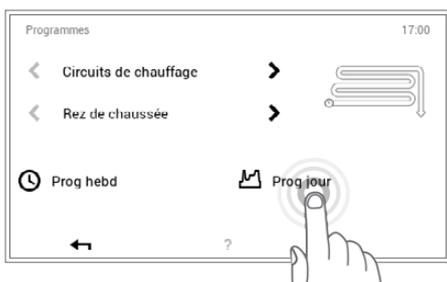
3 L'aperçu pour la sélection du circuit de chauffage et du programme s'affiche. Sélectionner d'abord le circuit de chauffage puis les **programmes journaliers**.
