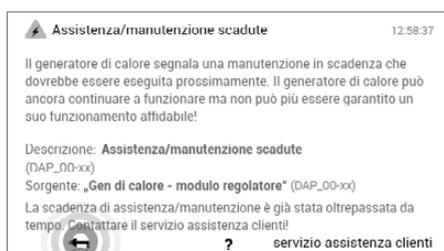
3 Comparare un messaggio di errore dettagliato. Il messaggio comprende informazioni dettagliate relative all'errore. Con **Indietro** (←) viene chiusa la visualizzazione del messaggio di errore.
