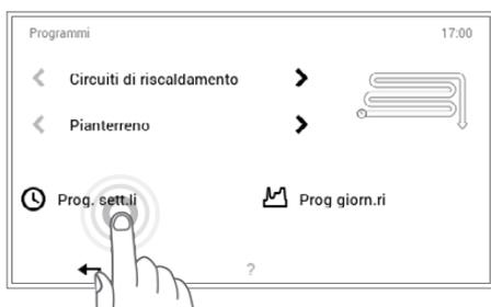
3 Compare la panoramica per la selezione del circuito di riscaldamento e del programma. Selezionare il circuito di riscaldamento desiderato e successivamente **Programmi settimanali**.
