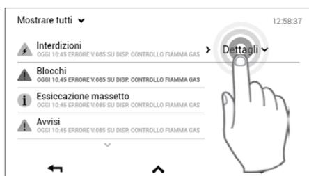
2 Selezionare mediante tocco **Dettagli** (▼).
