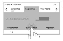
Gewünschtes Tagesprogramm (Beispiel: längerer Tag) mit den horizontalen Pfeilen (< >) anwählen. Durch Berühren der Schaltfläche Zurücksetzen werden die Einstellungen im angewählten Tagesprogramm auf die Standardwerte zurückgesetzt.
