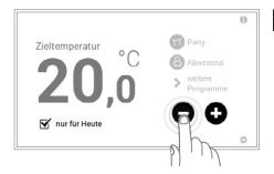
Durch mehrmaliges Berühren der Schaltfläche Plus (+) oder Minus (-) die gewünschte Raumtemperatur einstellen. Anschliessend 3 Sekunden bis zur Abspeicherung warten.
