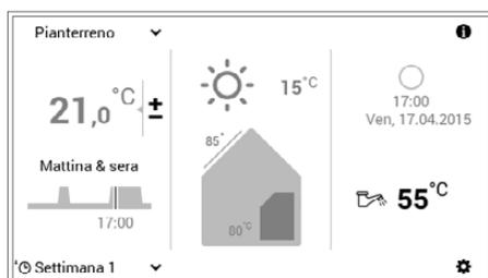
7 L'attuale temperatura dell'acqua calda viene visualizzata nella schermata di avvio e aumenta fino al raggiungimento della temperatura dell'acqua desiderata della ricarica.
