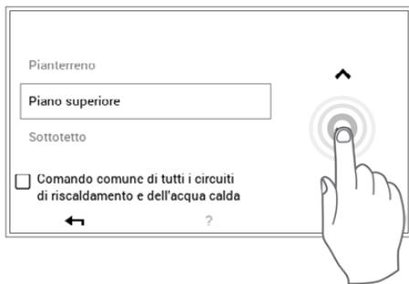
**2** Selezionare il circuito di riscaldamento mediante le **frecche verticali** (^v) e confermare con **OK**.
