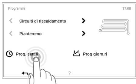
3 Comprire la panoramica per la selezione del circuito di riscaldamento e del programma. Selezionare il circuito di riscaldamento desiderato e successivamente **Programmi settimanali**.
