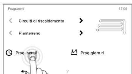
3 Compare la panoramica per la selezione del circuito di riscaldamento e del programma. Selezionare il circuito di riscaldamento desiderato e successivamente **Programmi settimanali**.
