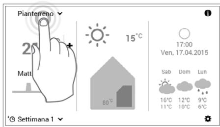
**1** Selezionare mediante tocco il **circuito di riscaldamento** visualizzato (esempio: Pianterreno).
