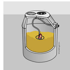
Citerne à granulés en béton avec système d'extraction par taupe
