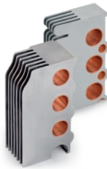
Echangeur de chaleur TopGas®: Mélange intelligent de matériaux composé d'aluminium conducteur et de cuivre résistant à la corrosion. La TopGas® combi (à l'arrière) possède un canal d'eau supplémentaire en cuivre pour la préparation d'eau chaude.
