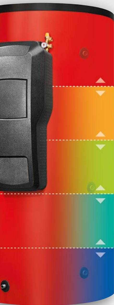
Accumulo combinato igienico a stratificazione, per riscaldare acqua potabile e acqua di riscaldamento. Accumulo per acqua di riscaldamento in acciaio con isolamento termico. Uno scambiatore di calore in acciaio installato per l'integrazione del solare, e un modulo di preparazione istantanea ACS esterno o uno scambiatore a tubo ondulato integrato per il riscaldamento diretto dell'acqua potabile.
