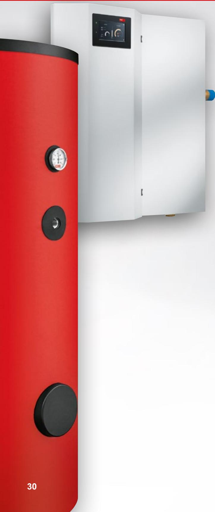
Stazione pronta all'allacciamento, per riscaldamento di acqua potabile in base al principio del flusso continuo istantaneo. Con scambiatori di calore a piastre in acciaio inossidabile, saldobrasati a rame. Sistema di regolazione TopTronic® E installato.
