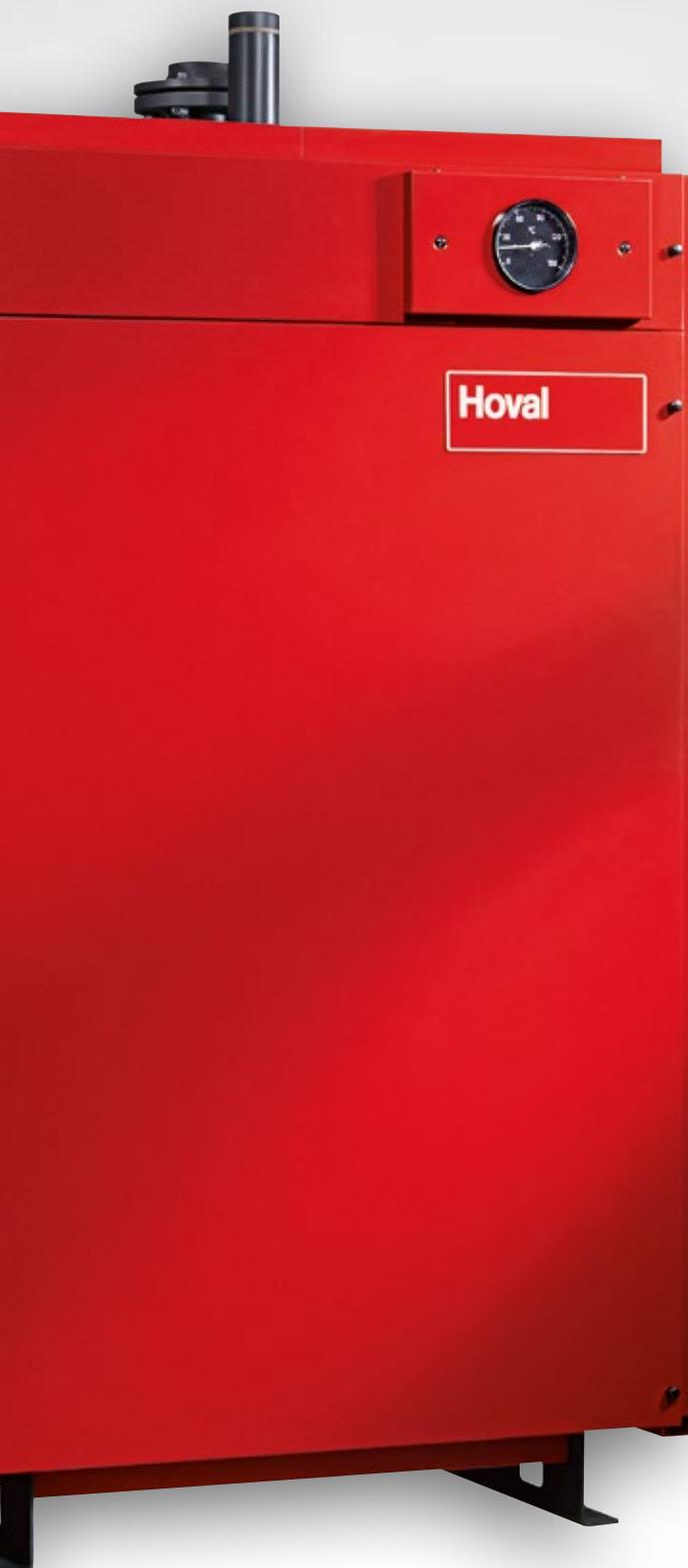
Hochleistungs-Trinkwassererwärmer zum Erwärmen von Trinkwasser im Gegenstromprinzip. Doppelmantel-Heizzellen aus Edelstahl mit Heizwassermantel aus Stahl mit Wärmedämmung. Einsatzbereich: grosser Warmwasserbedarf.
