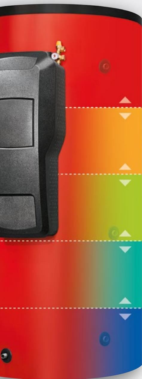
Hygiene-Kombispeicher mit Schichtprinzip zum Erwärmen von Trinkwasser und von Heizungswasser. Speicher für Heizungswasser aus Stahl mit Wärmedämmung. Ein eingebauter Wärmetauscher aus Stahl für die Solareinbindung und ein externes Frischwassermodul oder integrierter Wellrohrtauscher zum direkten Erwärmen von Trinkwasser.
