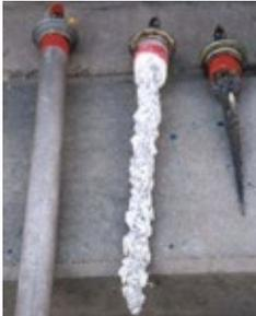
Das Bild zeigt, wie sich eine Magnesium- bzw. Opferanode in einem Trinkwassererwärmer mit der Zeit abbaut.
