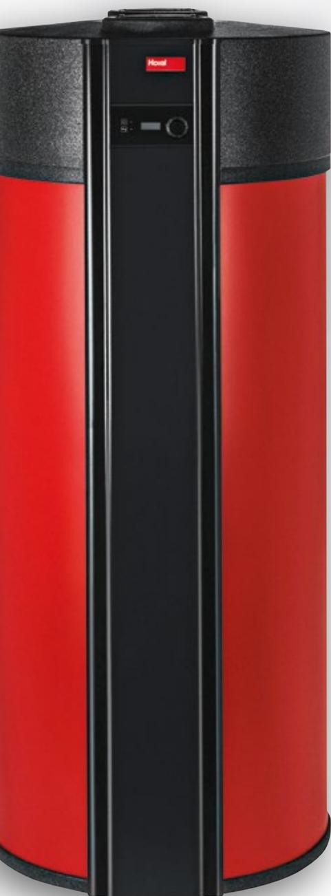
Anschlussfertiger Trinkwasserspeicher mit integrierter Luft-/Wasser-Wärmepumpe zum Erwärmen von Trinkwarmwasser. Speicher aus Stahl, innen emailliert, mit Korrosionsschutz und mit Wärmedämmung. Ausführung mit zusätzlichem, eingebautem Standard-Wärmetauscher erhältlich.
