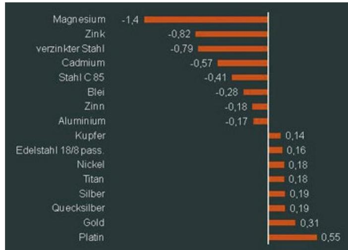
Als Grundsatz gilt: Das edlere Material baut das unedlere ab. Der Prozess ist stärker, je höher die Spannungsdifferenz.
