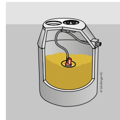
Serbatoio del pellet in cemento armato e sistema di trasporto con talpa
