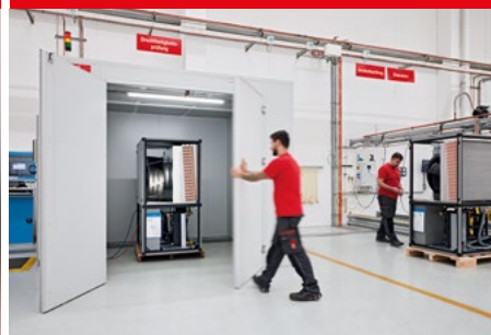
Prova di tenuta alla pressione
